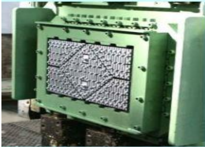
Mundstück = Stahlplatte mit Ziegellochung in umgekehrter Form
