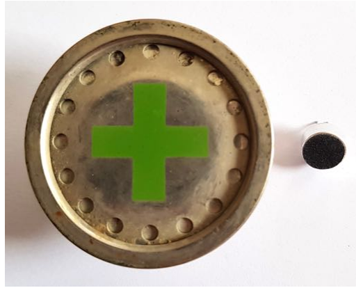
Abbildung 24: Kohlemikrofon (li.) und Elektretmikrofon (re.)
