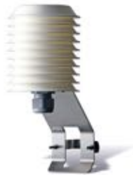
Abbildung 10: Wetterhütte für automatischen Sensor
