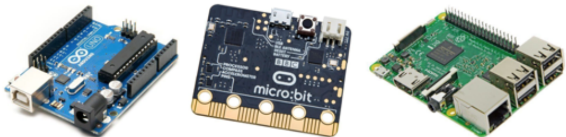
Abbildung 33: Arduino UNO, BBC micro:bit und Raspberry Pi 3B (v.l.n.r.)
